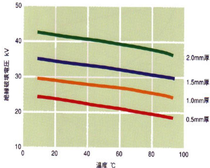
各温度における絶縁破壊電圧
