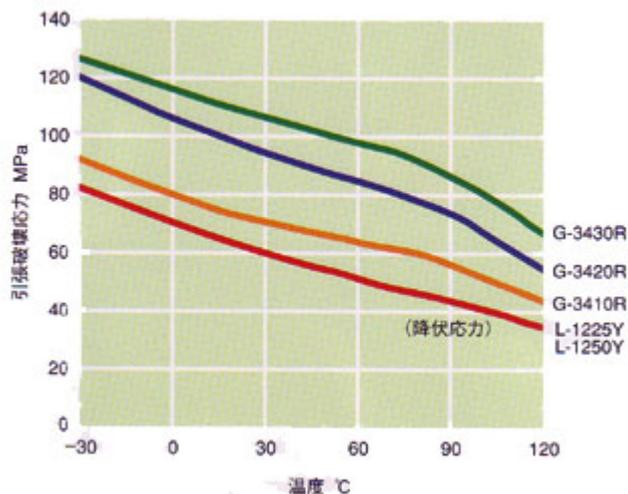
各温度における引張破壊応力
