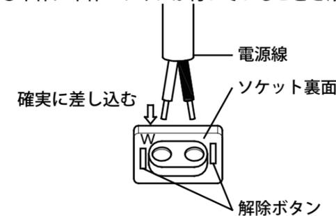
器具の取り替え等で電源線を外す場合は、マイナスドライバー等で解除ボタンを押しながら電源線を引き抜きます。
