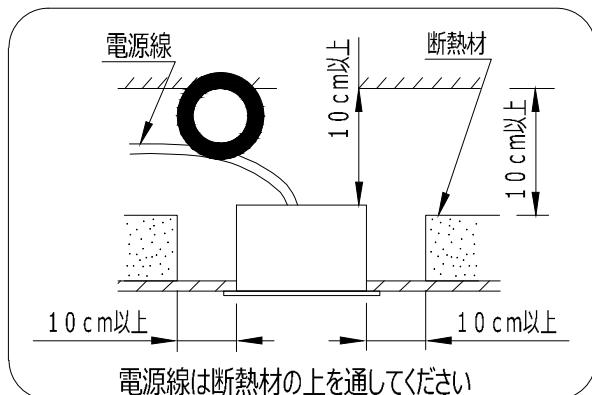
※断熱施工の住宅では使用できません。住宅以外で施工する場合は、器具と断熱材又は防音材との間に一定の離隔をとる必要があります。
