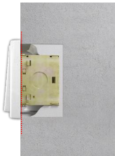
③埋め込みの深さは、壁面と揃えるか、壁面から20mm未満ほど離れるようにして設置します
