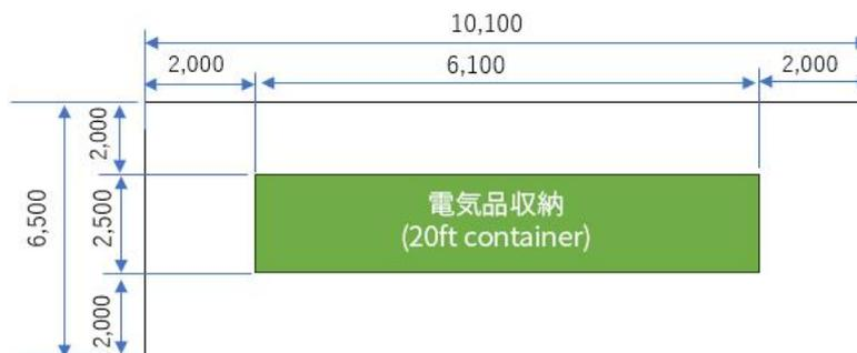
※20ft コンテナ設置用基礎は電解液荷重も考慮したべた基礎で計画下さい
