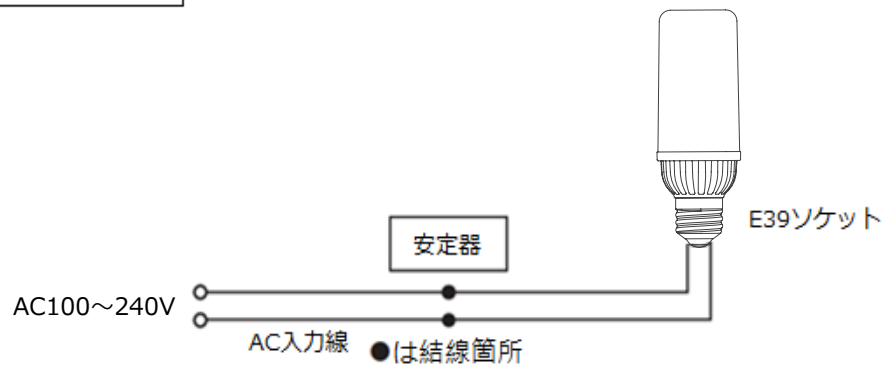
図②：結線後の配線
